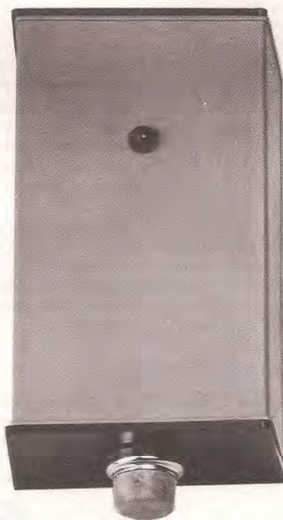
Fig. 11 Una volta chiusa l'elegante scatola plastica bicolore, dovrete fissarla alla parete della vostra stanza, tenendo la sonda rivelatrice rivolta verso il basso, come vedesi in questa foto. Come spiegato nell'articolo, non bisogna collocare tale sonda sopra ai fornelli, ma a una certa distanza da essi.
