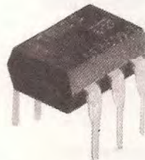
Fig. 2 Internamente ai piedini 1-2 fa capo il diodo emittente e ai piedini 4-5-6 il fototransistor ricevente.
